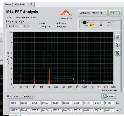
FFT zur frequenzselektiven Überwachung
